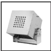
Le FirePro est un système d'extinction d'incendie innovant et respectueux de l'environnement. Le composé solide présent dans le système se transforme en un aérosol qui se propage rapidement et se répartit uniformément dans l'enceinte protégée. L'extinction se fait grâce au blocage des réactions chimiques produit dans les flammes et non par réduction de l'oxygène ou refroidissement. Le déclenchement du FirePro se fait par BTA (Bulbe Thermo Activateur)
