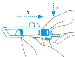
Appuyez sur le bouton de changement de lame et tirez l'insert en plastique vers l'arrière pour le sortir du manche.
