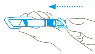
Refermez le cache-lame et repoussez l'insert en plastique dans le manche jusqu'à ce que le bouton de changement de lame fasse un **déclit**.
